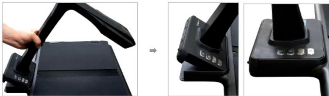
(2) クレードルベース底面に付属のネジを取り付けて固定して下さい。(下記画像の赤枠部分)
